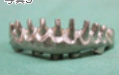
データに基づき、チタンブロックを削り出して作られた補綴物のフレーム。
